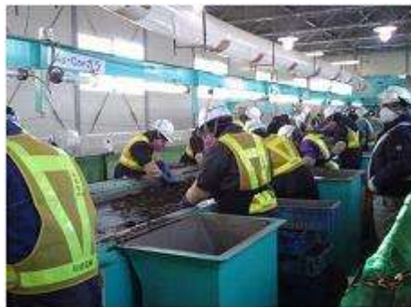
仮設施設内の手選別工程 (宮城県岩沼市、平成25年(2013年)2月)
